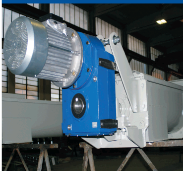
Motoriduttore accoppiato direttamente all'albero Motor-gear directly mounted on the drive shaft
