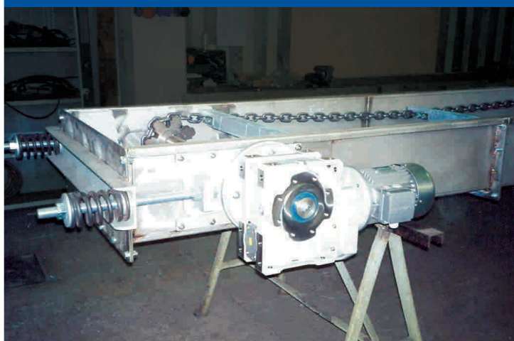
Testata motrice con sistema di tensionamento Drive head with take-up system
